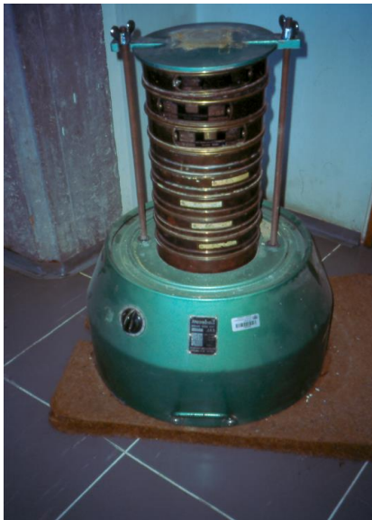
Slika 1: Oprema za sejalno analizo: sejalni stroj s stavkom sit za določanje zrnastosti zemljin s sejanjem in areometer (hidrometer) v merilnem valju
