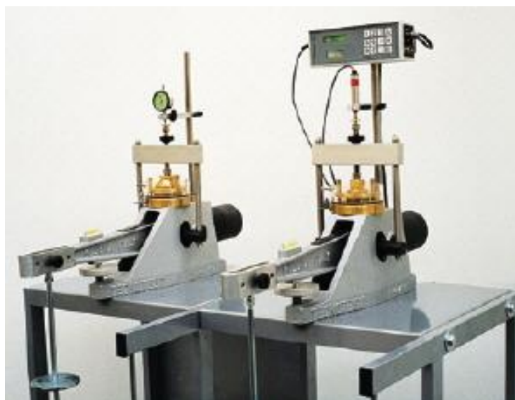
Slika 3: Edometer - celica nameščena na okvir za obremenjevanje z merilcem vertikalnih premikov – mikrometersko urico (levo) oziroma elektronskim merilcem posedkov (desno)
