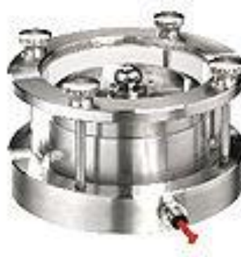
Slika 2: Edometerska celica (sestavljena)
