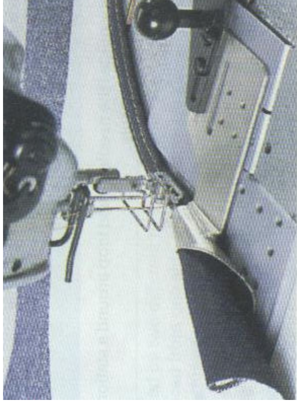
Šivalni stroj z vodilom za ploščate šive – dvojno podvihani šiv
