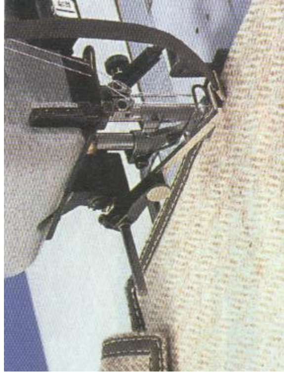
Šivalni stroj z vodilom za našivanje trakov
