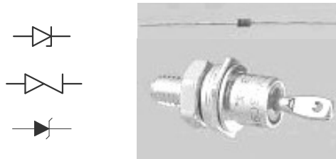
Slika 2.11 Simboli i primjeri izvedbe Zenerovih dioda
