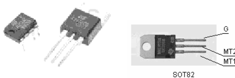
Slika 2.8.1 Primjeri izvedbe thyristora
