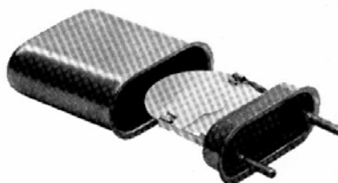
Slika 5.9: Pritrditev elektrod na ploščico kvarca in vgradnja v ohišje
