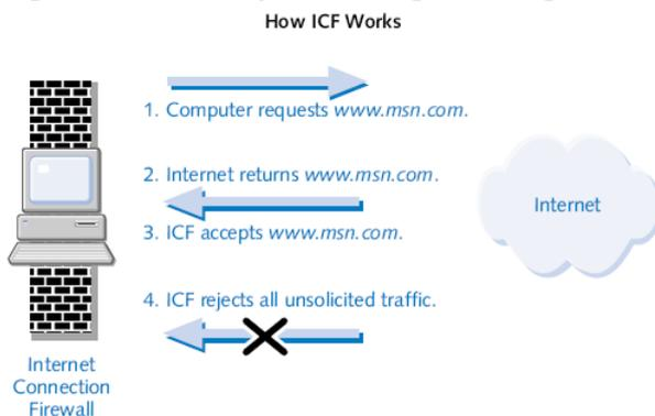
Z ICF lahko tudi varujemo celotno omrežje, če uporabimo računalnik, ki se direktno povezuje na Internet z uporabo Internet Connection Sharing. Ves promet se potem nadzoruje preko enega računalnika, kot je pokazano na spodnji sliki
