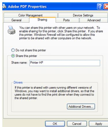
Na drugih računalnikih lahko dodamo tiskalnik (Add printer), kakor omrežni tiskalnik. V čarovniku izberemo naprej (Next), dodamo mrežni tiskalnik in nato dodamo IP naslov računalnika na katerem je tiskalnik nameščen za skupno rabo in ime računalnika, bi se moral izpisati avtomatsko.
