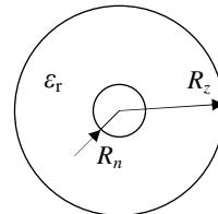
67. Kabel je izoliran z dvema slojema dielektrikov ( $\epsilon_{r1} = 2$  in  $\epsilon_{r2} = 6$ ). Dimenzijs kabla so:  $R_n = 0,5 \text{ cm}$ ,  $R_{sr} = 1 \text{ cm}$  in  $R_z = 2 \text{ cm}$ . Poznamo napetost na notranjem sloju dielektrika  $U_1 = 6 \text{ kV}$ . Izračunajte napetost na zunanjem dielektriku in skupno napetost med žilo in plaščem tako, da upoštevate obe plasti dielektrikov kot zaporedno vezavo kondenzatorjev. Računajte na enoto dolžine.
