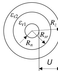
61. Kabel je izoliran z dvema slojema dielektrikov ( $\epsilon_{r1} = 4$  in  $\epsilon_{r2} = 2$ ). Izračunajte minimalno električno poljsko jakost v notranjem dielektriku, če je napetost med žilo in plaščem 3 kV ( $R_n = 0,5 \text{ cm}$ ,  $R_{sr} = 1 \text{ cm}$  in  $R_z = 1,5 \text{ cm}$ ).
