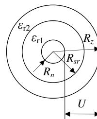
68. Kovinski valj z dimenzijsami  $R_n = 4 \text{ mm}$ ,  $R_{sr} = 6 \text{ mm}$  in  $R_z = 8 \text{ mm}$  je obdan z dvema slojema izolatorjev ( $\epsilon_{r1} = 5$  in  $\epsilon_{r2} = 8$ ). Prebojna trdnost zunanjega izolatorja je  $E_{p2} = 4 \cdot 10^6 \text{ V/m}$ . Izračunajte kakšne so največje dovoljene napetosti na posameznih plasteh izolatorjev in skupna napetost, da zunanj izolator še ne bo prebil. Izračunajte še kapacitivnost kabla (valja) na dolžini 3 km.
