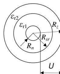
63. Enožilni kabel ima notranji polmer  $R_n = 2 \text{ cm}$  in zunanji polmer  $R_z = 4 \text{ cm}$ . Izolacija ima relativno dielektrično konstanto  $\epsilon_r = 3$ . Izračunajte kapacitivnost kabla na dolžini 3 km.
