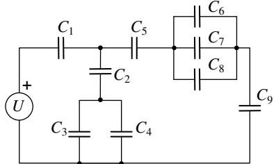
76. Izračunajte naboje na kondenzatorjih v vezavi na sliki. Podatki elementov so:  $C_1 = 6 \text{ pF}$ ,  $C_2 = 4 \text{ pF}$ ,  $C_3 = 4 \text{ pF}$ ,  $C_4 = 6 \text{ pF}$ ,  $C_5 = 10 \text{ pF}$ ,  $C_6 = 3 \text{ pF}$  in  $U = 10 \text{ V}$
