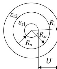
60. Kabel je izoliran z dvema slojema dielektrikov ( $\epsilon_{r1} = 6$  in  $\epsilon_{r2} = 4$ ) in ima dimenzijs:  $R_n = 1 \text{ cm}$ ,  $R_{sr} = 2 \text{ cm}$  in  $R_z = 4 \text{ cm}$ . Izračunajte napetosti na posameznih slojih dielektrikov in minimalno električno poljsko jakost v notranjem dielektriku, če je napetost med žilo in plaščem 2 kV.
