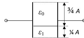
53. Ploščati kondenzator s površino plošč  $1 \text{ m}^2$  in razdaljo med njima 4 cm nabijemo z naboјem  $Q_0=19 \cdot 10^{-6}$  As, nato izvor odklopimo. Zatem napolnimo kondenzator do  $\frac{3}{4}$  prostornine z dielektrikom, ki ima  $\epsilon_r=6$  tako, kot je prikazano na sliki. Izračunajte napetost med ploščama.
