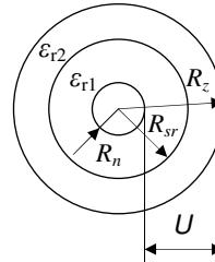
59. Krogelni kondenzator je izoliran z dvema slojema dielektrikov, ki imata relativni dielektrični konstanti  $\epsilon_{r1} = 6$  in  $\epsilon_{r2} = 3$ . Dimenzijs krogle so:  $R_n = 2 \text{ cm}$ ,  $R_{sr} = 4 \text{ cm}$  in  $R_z = 8 \text{ cm}$ . Na zunani plast dielektrika je napetost  $U_2 = 2 \text{ kV}$ . Izračunajte skupno napetost na kondenzatorju, napetost na notranji plast dielektrika in maksimalno električno poljsko jakost v zunanjem dielektriku in kapacitivnost.
