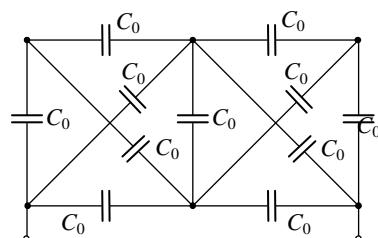
72. Izračunajte nadomestno kapacitivnost vezave enakih kondenzatorjev  $C_0 = 12,5 \text{ nF}$ .
