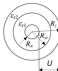
62. Krogelni kondenzator je izoliran z dvema slojema dielektrikov, ki imata relativni dielektrični konstanti  $\epsilon_{r1} = 2$  in  $\epsilon_{r2} = 4$ . Skupna napetost med elektrodo in zunanjim kovinskim plaščem je  $U = 3 \text{ kV}$ . Izračunajte površinsko gostoto naboja na kovinskem plašču ( $R_n = 2 \text{ cm}$ ,  $R_{sr} = 2,5 \text{ cm}$  in  $R_z = 4 \text{ cm}$ ).
