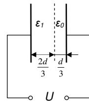
55. Na ploščati kondenzator, v katerem sta zaporedno nameščena dva dielektrika z  $\epsilon_{r1}=9$  in  $\epsilon_{r2}=3$  in ima razmik med elektrodama  $d=6 \text{ cm}$ , je priključena napetost  $U=5 \text{ kV}$ . Izračunajte površinsko gostoto elektrine  $\sigma$ , električni poljski jakosti v obeh dielektrikih in napetosti na posameznih slojih dielektrikov  $U_1$  in  $U_2$ .
