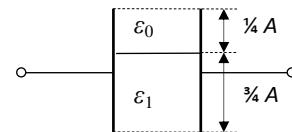
54. Med dvema vzporednima ploščatima elektrodama s površino  $A=1 \text{ m}^2$  je do  $\frac{2}{3}$  globine nameščen dielektrik z  $\epsilon_{r1}=8$ , kot je prikazano na sliki. V preostalem prostoru je zrak. Na elektrodi priklopimo napetost 1 kV. Ugotovite, če v zraku, ki ima prebojno trdnost  $E_p=2 \text{ MV/m}$ , pride do preboja.
