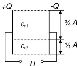
57. Na ploščati kondenzator s površino plošč  $A = 1 \text{ m}^2$  je priključena napetost  $U = 1 \text{ kV}$ . Izračunajte naboj na ploščah, če je dielektrik zrak in, če  $\frac{1}{4}$  prostora med ploščama napolnimo z dielektrikom, ki ima  $\epsilon_r = 4$  (tako, kot je prikazano na sliki). Izračunajte tudi napetosti na plasti zraka in dielektriku.
