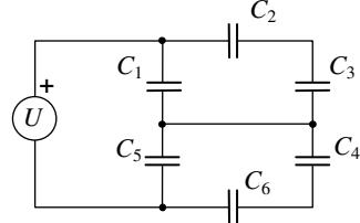
77. Izračunajte napetosti na kondenzatorjih v vezavi na sliki. Podatki elementov so:  $C_1 = 6 \text{ pF}$ ,  $C_2 = 4 \text{ pF}$ ,  $C_3 = 4 \text{ pF}$ ,  $C_4 = 6 \text{ pF}$ ,  $C_5 = 10 \text{ pF}$ ,  $C_6 = 3 \text{ pF}$  in  $U = 10 \text{ V}$
