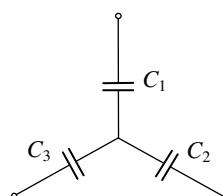
71. Izračunajte nadomestno kapacitivnost vezave enakih kondenzatorjev  $C_0 = 12 \text{ pF}$ .
