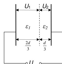
56. V ploščatem kondenzatorju s površino plošč  $A=30 \text{ cm}^2$  in razmikom med ploščama  $d=2 \text{ cm}$  sta vzporedno nameščena dva dielektrika z relativnimi dielektričnimi konstantama  $\epsilon_{r1}=3$  in  $\epsilon_{r2}=9$ . Izračunajte gostoto električnega pretoka  $D$  v obeh dielektrikih in priklučeno napetost, če poznate elektrino na ploščah  $Q=10^{-6} \text{ As/m}^2$ .
