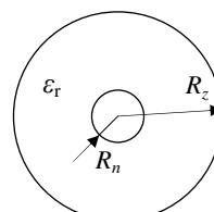
64. Določite zunanji polmer sferičnega kondenzatorja, če je njegova kapacitivnost  $175 \text{ pF}$ , dielektrik ima relativno dielektrično konstanto  $\epsilon_r = 18$  in notranji polmer  $R_n = 2,5 \text{ cm}$ .
