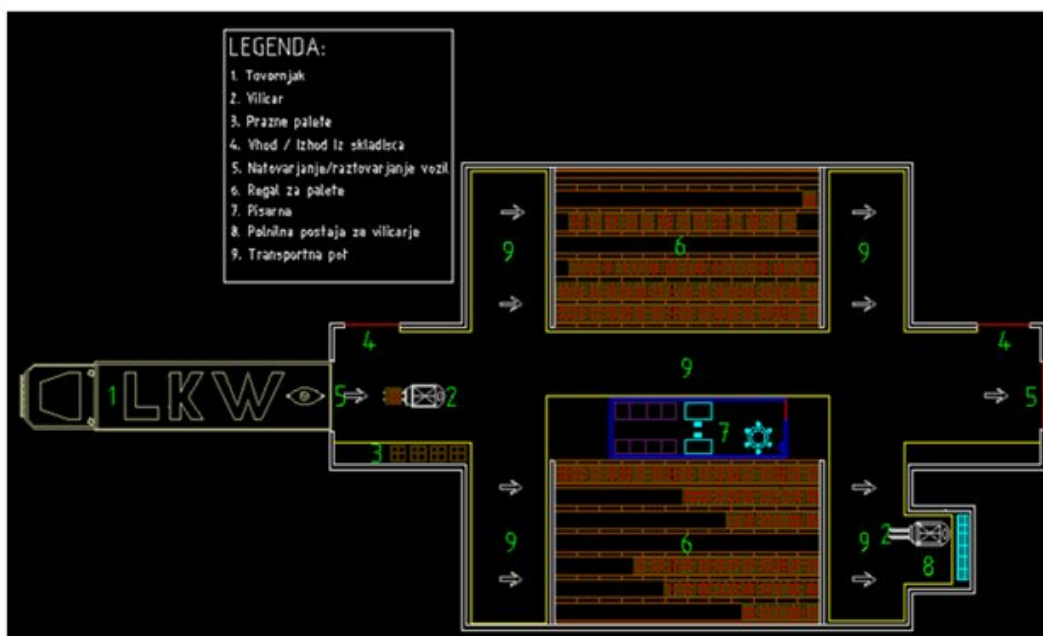
Slika 8.18: Skica skladiščnega prostora
