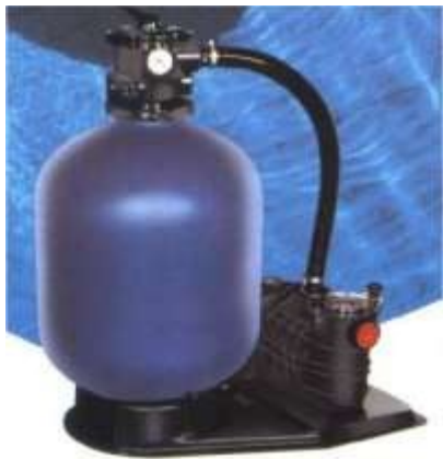
TOP filter s črpalko in 6 potnim izbirnim ventilom, fi 480, 75 kg peska
