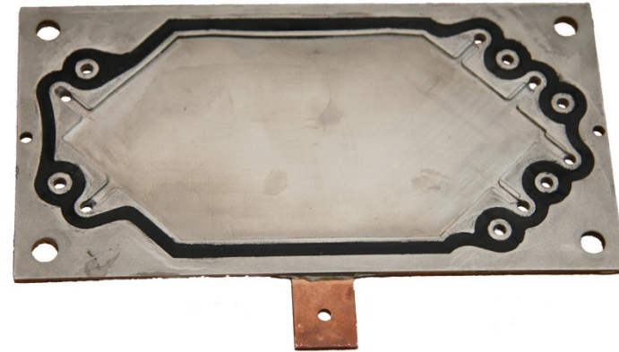
Zračno hlajena bipolarna plošča z izboljšano geometrijo aktivnega polja
