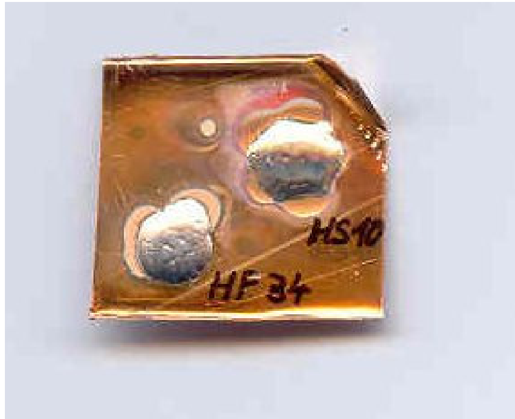
Rezultat testiranja omočljivosti STANNOL-ovih spajkalnih žic HF 34 (levo) in HS 10 (desno)
