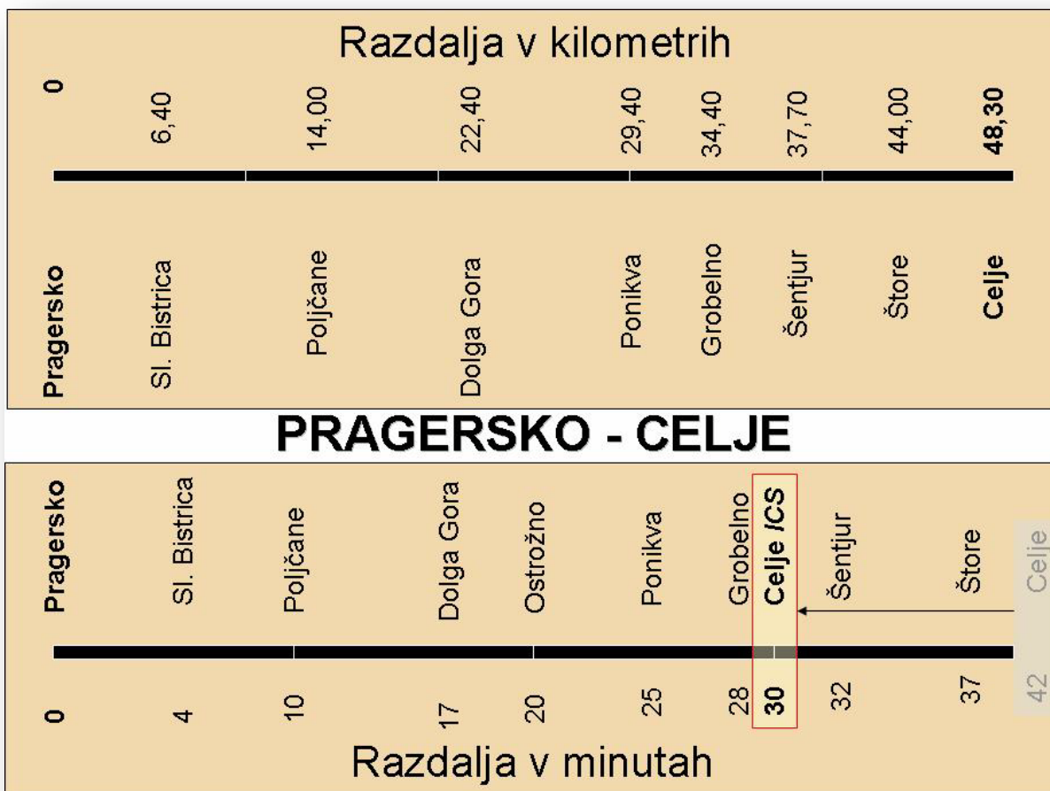
Slika 29: Fizične in časovne razdalje med postajami na odseku proge Pragersko-Celje (po voznem redu za leto 2007)
