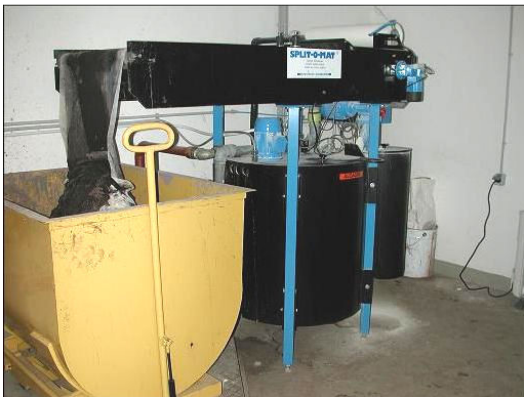
Slika 9: Čistilna naprava, ki deluje po principu obarjanja Vir: http://www.htb.si/galerija/cistilna.php/ (18. 10. 2009)
