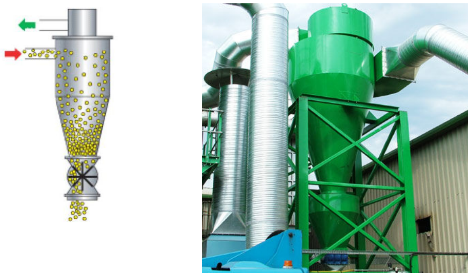
Slika 45: Ciklon – zračni separator proizvajalca AFT
