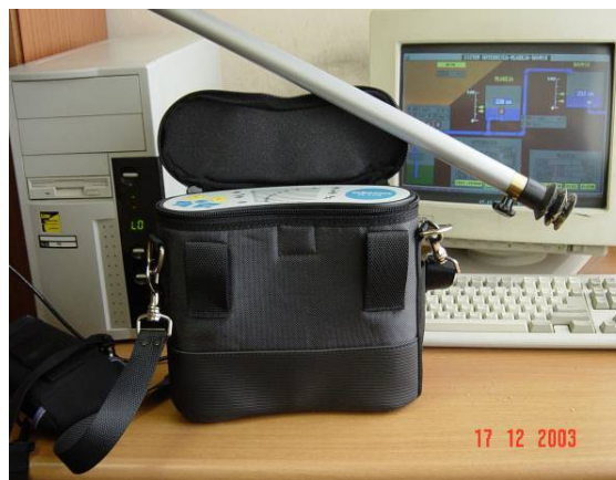
Slika 96: Naprava (geofon) za iskanje poškodovanega mesta, kjer izteka voda Vir: Lasten
