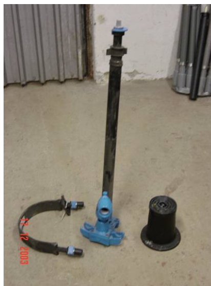
Slika 65: Zasun (deli, potrebni za vgradnjo) Vir: Lasten
