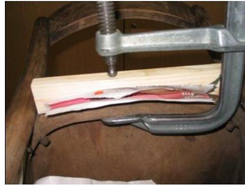
**Slika 23: ...lepljenje lameliranega sedežnega oboda, ki je popustil v spoju ... (Vir: lasten)**
