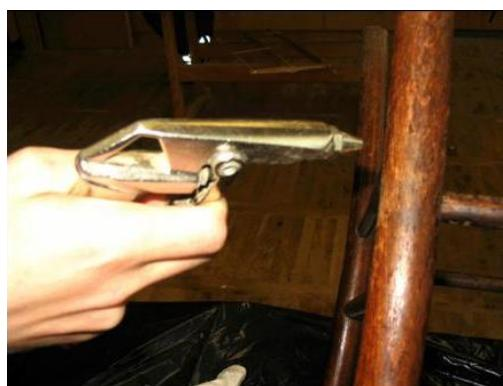
**Slika 14:** ...očiščene dele pa smo sproti sušili s stisnjениm zrakom.
