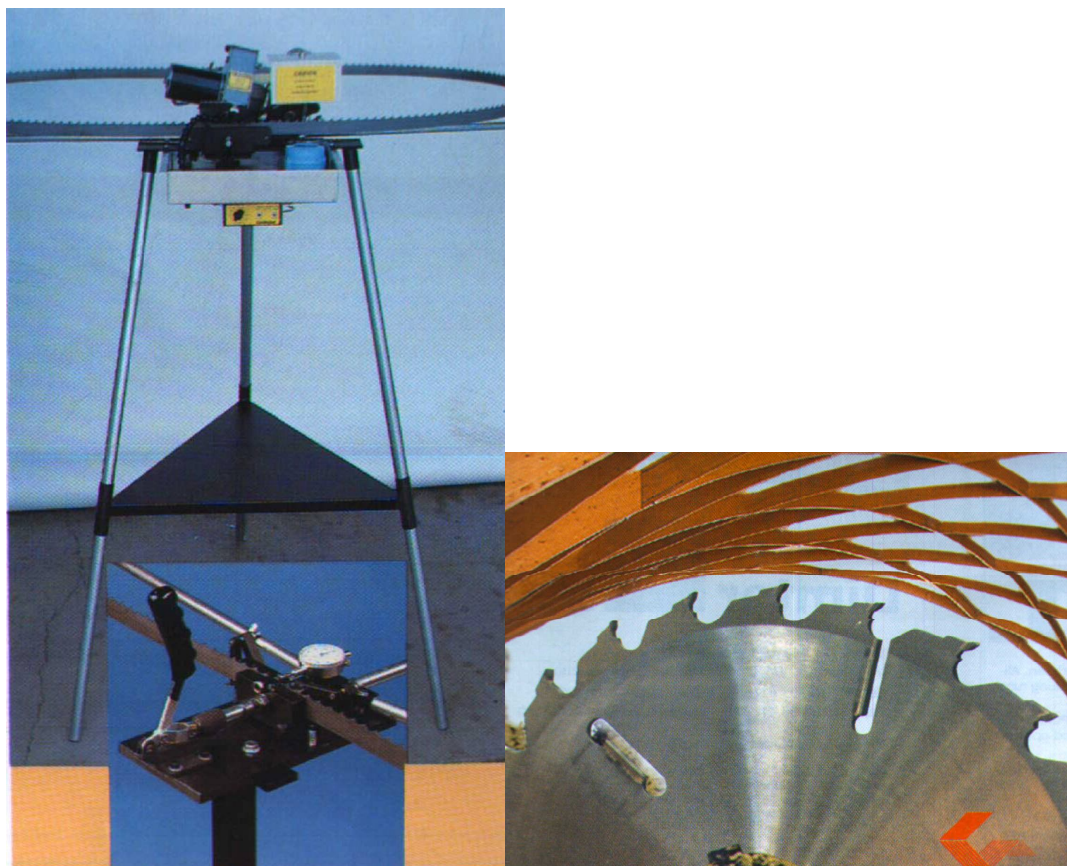
3.1.2.1.01 Slika: tračna žaga-ostrenje in razperjanje ( Wood-Mizer, Indianapolis, Indiana 46224,USA )
