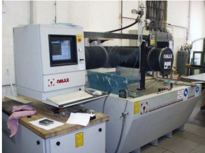
Slika 8: Stroj za obdelavo z AVC podjetja Omax
