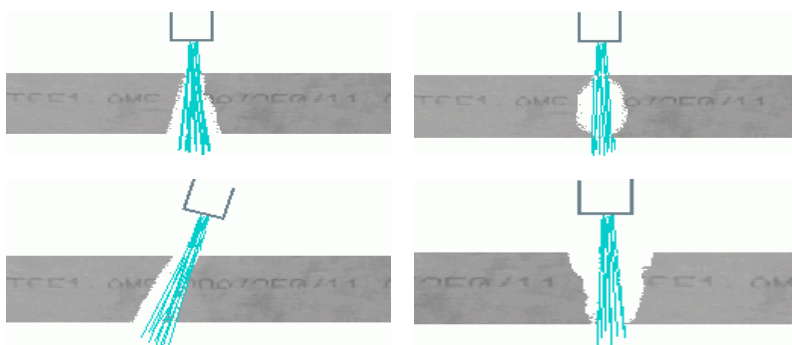
Slika 7: Pojav koničnosti in različnih deformacij pri rezanju
