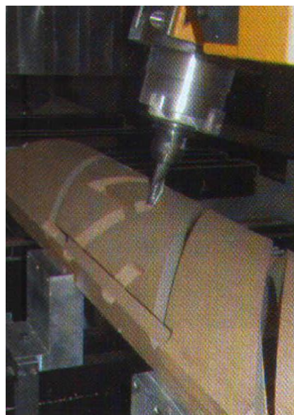
6.2.04 Slika: pet osna obdelava masivnega lesa; HOLZ Design, Leopoldsdorf/Wien, 03.2002
