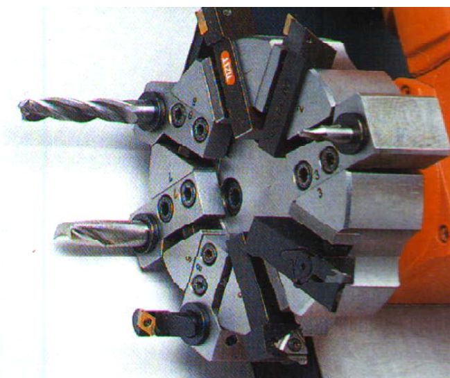
6.2.05 Slika: zalogovnik orodji; ( Maschinen im Spiegel Ausgabe, präzision im spiegel, 2/1988)
