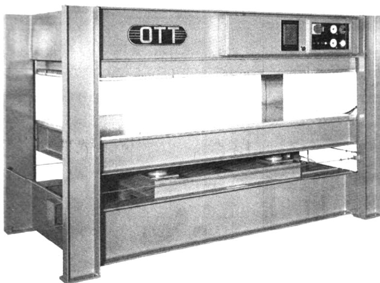
5.5.04 Slika: univerzalna vroča hidravlična stiskalnica; (WOODWORKING INTERNATIONAL, D-8500 Nuernberg 1, FED.REP. GERMANY, april 1987) 54
