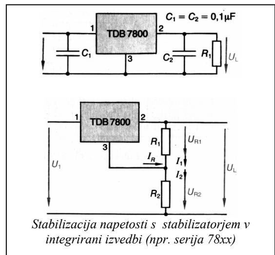
Kot linearni stabilizatorji so večinoma v uporabi številne izvedbe integriranih serijskih stabilizatorjev (npr. MC 78xx, MC 79xx, ...), ki omogočajo zelo dobro stabilizacijo in so temperaturno zaščiteni. Integrirani stabilizatorji so lahko narejeni za fiksno ali pa za nastavljivo izhodno napetost. Poleg tega omogočajo v različnih vezavah še številne druge možnosti (npr. zviševanje napetosti, tokovno omejitve, kratkostično zaščito, tokovno stabilizacijo, AM modulacijo,...).
