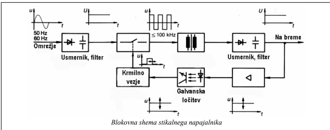
Stikalni napajalnik primarno enosmerno napetost (izmenična je predhodno usmerjena in glajena) s pomočjo elektronskega stikala »razseka« in energijo transformira na sekundarno stran, kjer se ponovno usmeri in gladi. Glede na to, da deluje na osnovi prehodnih pojavov je potrebno še regulacijsko vezje, ki regulira čas trajanja odprtja stikala in s tem velikost napetosti na izhodu. Glede na način delovanja lahko stikalne napajalnike razdelimo na zaporne in pretočne .
