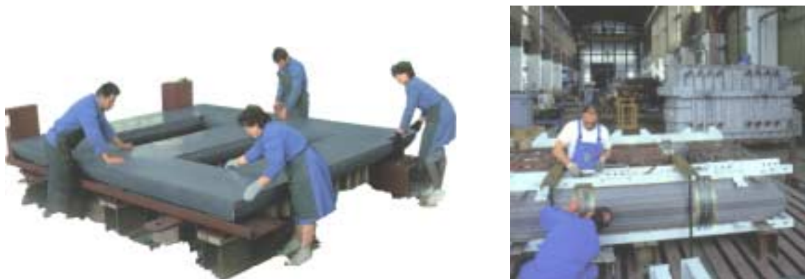
Zlaganje lamel jedra za trifazni transformator za distribucijo električne energije
