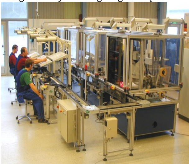
Slika 4. Ročna in avtomatizirana montažna mesta povezana s paletnim prenosom.
