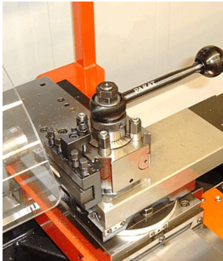
Vpenjalna glava za orodja na klasični in CNC stružnici
