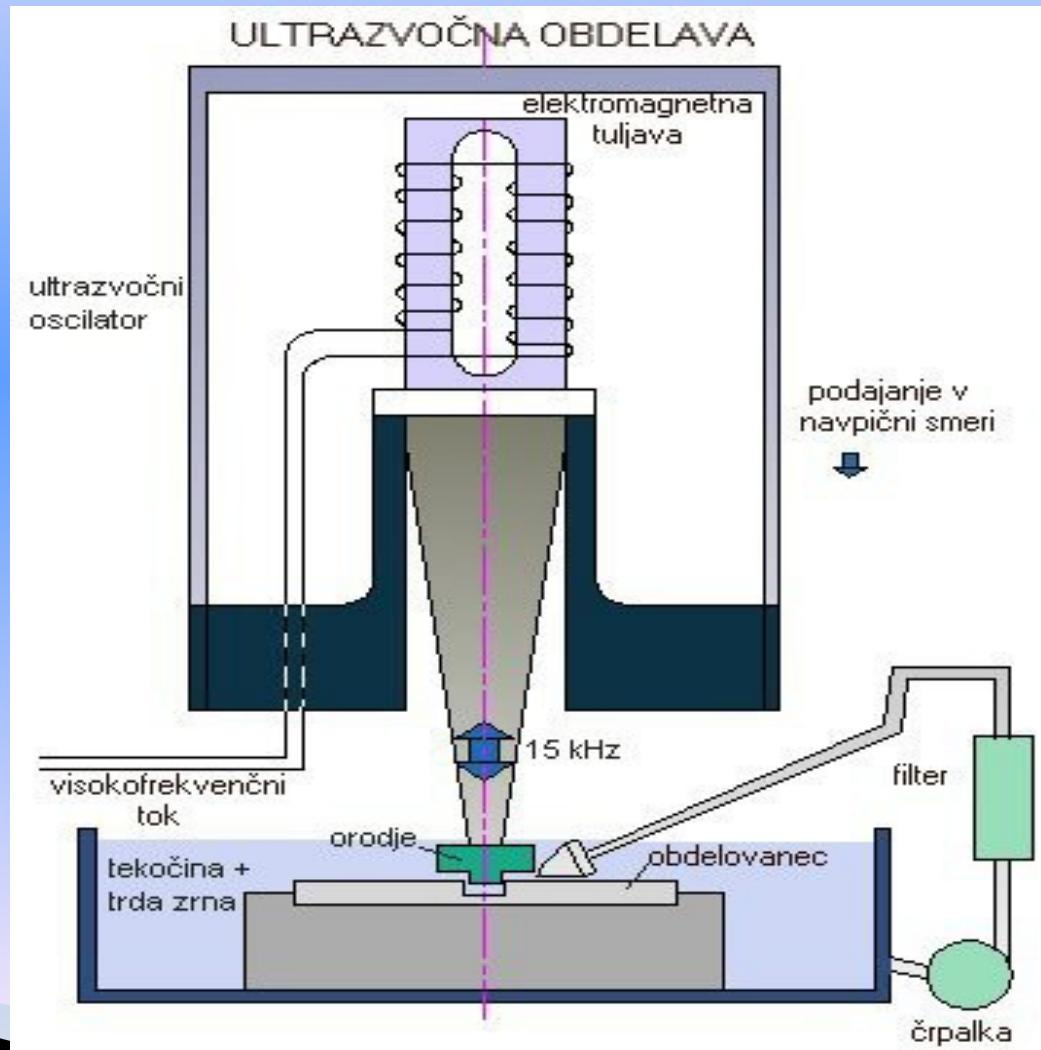
Zrna ( krund, silicijev karbid, diamant ) nihajo bolj ali manj pravokotno na površino obdelovanca ter na površino orodja in odrezujejo majhne delčke materiala. S pravilno izbranimi materiali zrna odsekavajo več materiala iz obdelovanca. Obrabljajo se tudi zrna - zlasti izgubljajo ostre robove, zato s pomočjo črpalk na delovno mesto prinašamo vedno nova zrna. Razdalja med orodjem in obdelovancem ostaja ves čas enaka.
