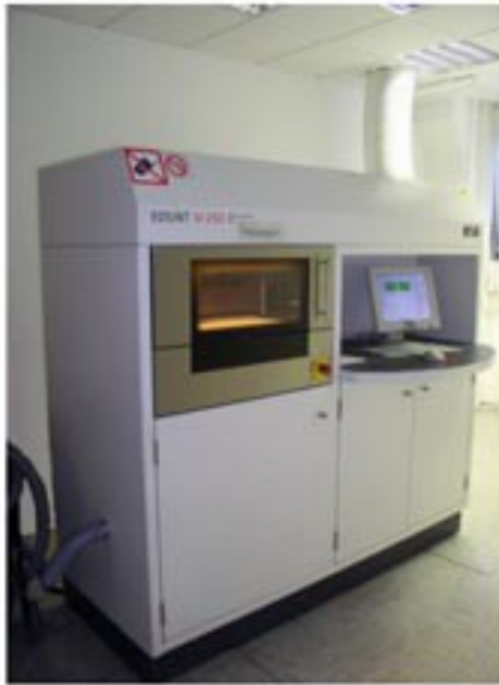
Stroj EOSINT M 250 Xtended in princip delovanja laserskega sintranja
