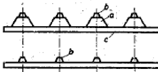
Si.3.6 Enodelni modelni plošči a) model, b) jedrni nastavek, c) plošča
