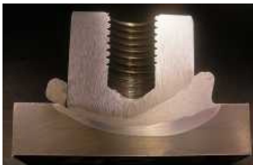
Slika 48: Metalografska preiskava zvarnega spoja
