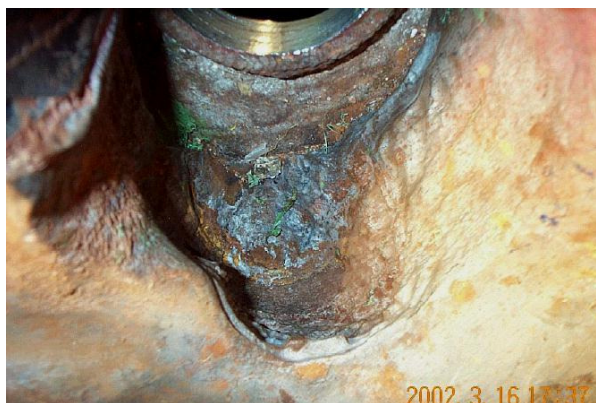
Slika 52: Kavitacija na reaktorju
