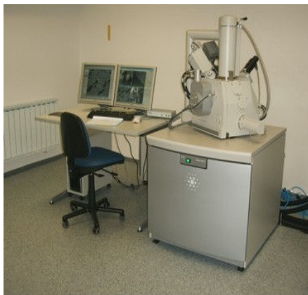
Slika 8: Vrstični elektronski mikroskop Quanta 200 3D Vir: http://ucem.uni-mb.si/Quanta.htm/ (30. 08. 2010)
