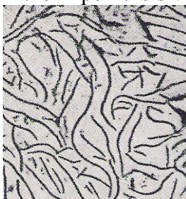
Slika 24: Siva litina z lamelarnim grafitom vrste A (50 : 1)
