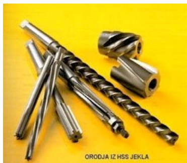
Slika 21: Rezalna orodja iz hitroreznega jekla
