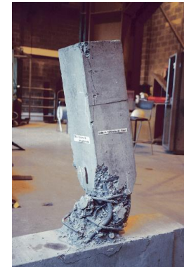
Armiran beton vzdrži večje obremenitve kot navaden
