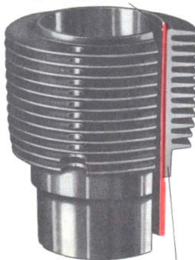
zračno hlajen aluminijev plašč bimetalno litje
