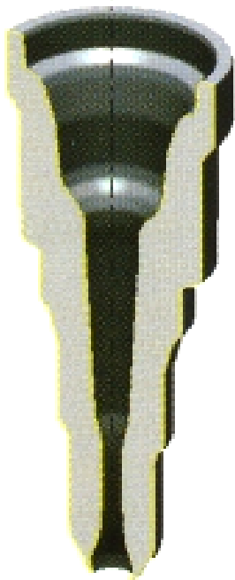
Umformziel: Achsschenkel (Querschnitt)
